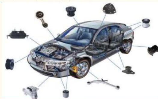
公司橡胶减震器在汽车中的应用
